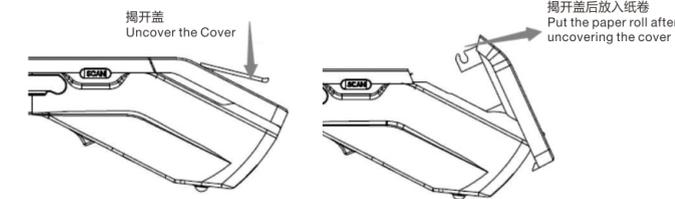
**打印机:** 本设备支持58MM的热敏打印纸, 规格为: 57\*40 (纸卷直径) 单位mm 通过上方的开盖提手揭开打印机的纸仓盖, 按正确的方向, 放入适合规格的纸卷, 并将纸拉出部分纸至切纸器外, 盖好纸仓盖完成打印机装纸。
