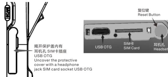
**SIM卡:** 支持MICRO卡插入, 网络支持3G/4G双网通。注意插入SIM时请确认设备处于关机状态下进行操作, 以免造成机器设备故障及不必要的损失!
