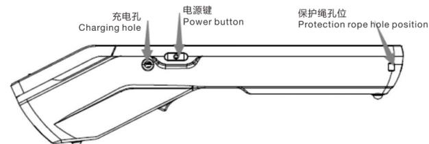
**充电孔:** 外径3.5mm内径: 1.35mm. 输入12V 1.5A进行设备充电。本设备只支持此孔充电, 不支持USB充电, 充电状态时屏幕会有相应图标提示, 如没有充电图标显示, 请检查充电器是否插好到位。此孔应防止进入液体或短路, 禁些插入非指定充电装置!
